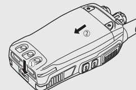
拆卸方法则反之，向下推动电池组上的释放门，向外扳动即可卸下电池组。
