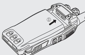
将电池组沿着对讲机的背面推到对讲机底座上的释放门锁定为止。
